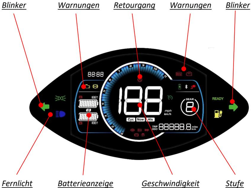
**Blinker**: Zeigt an in welche Richtung der Fahrtrichtungsanzeiger aktiv ist. Die Anzeige blinkt grün links oder rechts am Display.
