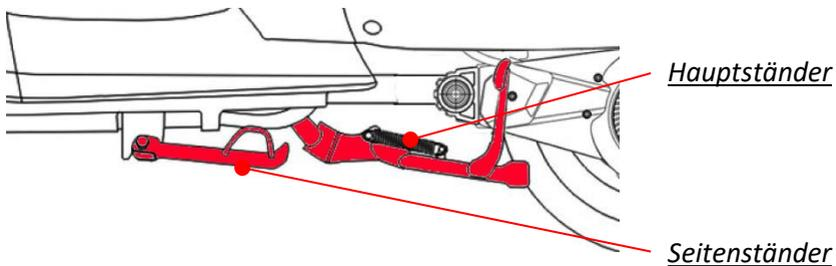
Der Hauptständer bietet einen sichereren Stand als der Seitenständer und eignet sich vor allem für Wartungs- und Reinigungsarbeiten am Fahrzeug aber auch für das Abstellen auf weicherem oder unebenem Grund. Stellen Sie bei Steigungen sicher, dass das Fahrzeug nicht wegrollen kann.
