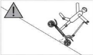
Vermeiden Sie das Beschleunigen abwärts. Bremsen Sie nicht zu stark mit der Vorderradbremse.
