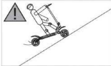
Fahren Sie keine langen Strecken mit Steigungen über 20°.
