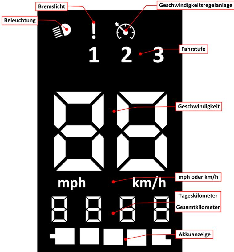
**Fahrstufe:** Die zu fahrende Höchstgeschwindigkeit kann in drei Stufen eingestellt werden.
