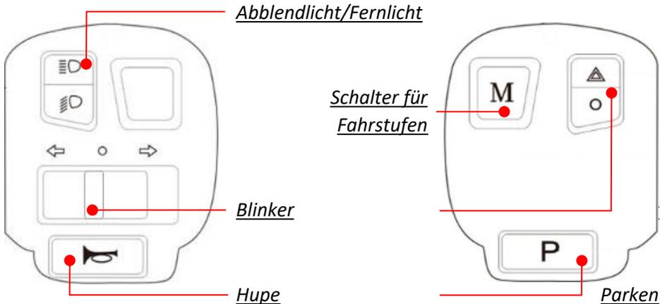
**Fernlicht:** Mittels dieser Taste kann zwischen Abblendlicht und Fernlicht gewählt werden. Für Fernlicht drücken Sie die Taste im oberen Bereich für Abblendlicht im unteren Bereich.
