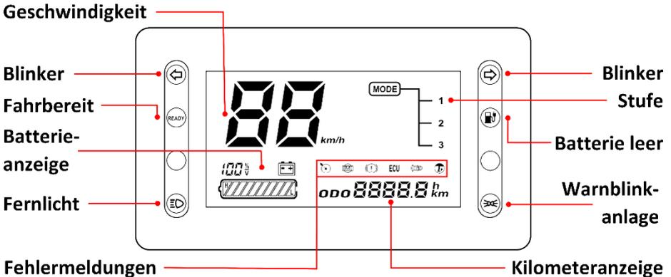
Geschwindigkeit: Hier wird die gegenwärtig gefahrene Geschwindigkeit angezeigt.
