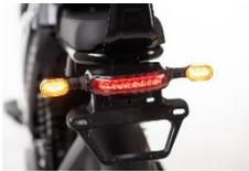
Die Beleuchtung des Fahrzeugs besteht aus dem weißen LED-Hauptscheinwerfer mit Tagfahrlicht (LED-Ring) vorne und der roten LED-Beleuchtung hinten. Verwenden Sie diese unbedingt bei schlechten Sicht- und Lichtverhältnissen.
