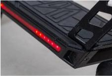
Die Beleuchtung des Fahrzeugs besteht aus dem weißen LED-Hauptscheinwerfer vorne, der LED-Seitenbeleuchtung und der roten LED-Beleuchtung hinten. Verwenden Sie diese unbedingt bei schlechten Sicht- und Lichtverhältnissen.
