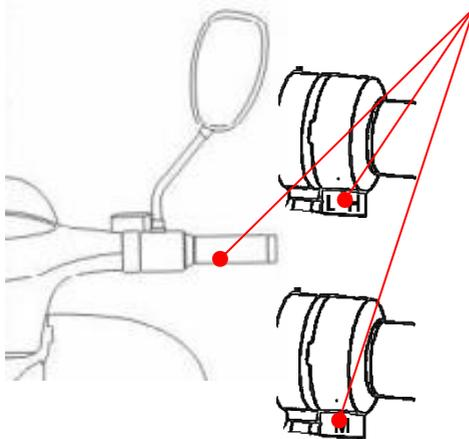
Schalter für Fahrstufe: Mittels des Schalters für die Fahrstufe, kann zwischen Stufe L für Niedrig und Stufe H für Hoch gewählt werden.
