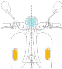
Die Beleuchtung des Fahrzeugs besteht aus dem weißen LED-Hauptscheinwerfer mit Tagfahrlicht vorne (hellblau markiert) und der roten LED-Beleuchtung hinten (rot markiert). Verwenden Sie diese unbedingt bei schlechten Sicht- und Lichtverhältnissen. Zusätzlich sind Fahrtrichtungsanzeiger verbaut (gelb markiert).
