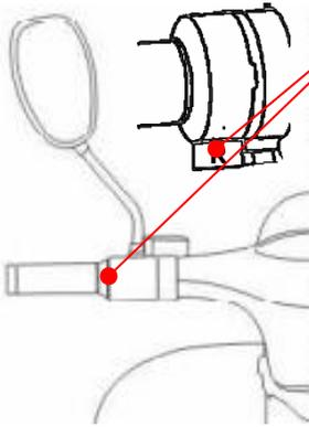
Schalter für Rückwärtsgang: Während des Drückens des Schalters für den Rückwärtsgang, kann das Fahrzeug mittels Ansteuerung über den Gasgriff durch den Motor Rückwärts bewegt werden. Zu Ihrer eigenen Sicherheit nur bis maximal 6 km/h und mit geringerer Kraft am Motor. Der Schalter befindet sich auf der linken Seite am Lenker.
