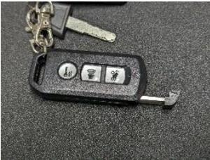
Ziehen Sie an der Unterseite der Funkfernbedienung den Notstartschlüssel heraus.
